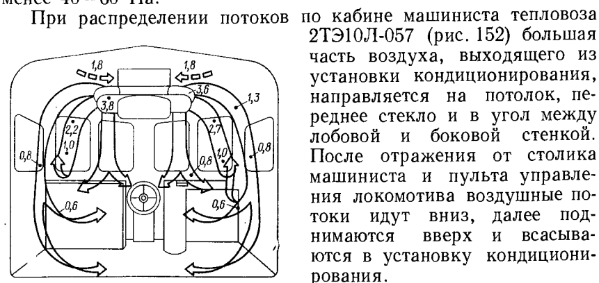
Рис. 152. Распределение потоков охлажденного воздуха по кабине. Цифрами указана скорость воздуха в м/с
